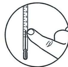
**TIP:** Instalace pásky v zimním počasí může být i při čistém povrchu náročnější. Lepený povrch i pásku samotnou je potřeba zahřát nejméně na 10 °C. Při zahřívání se často na povrchu sráží vlhký vzduch a pásku tak není možné nalepit. Tomu lze v některých případech předejít vhodným zdrojem tepla, např. fénem na vlasy nebo přenosným infrazářičem, který povrch zahřeje a vysuší. Obecně však aplikaci pásky pod 10°C nedoporučujeme.
